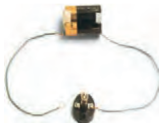
شکل ۵-۸ قطع شدگی در مدار
