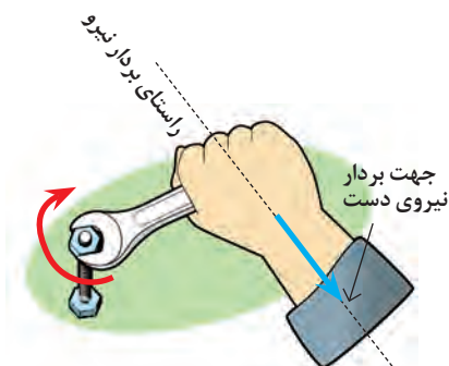
شکل ۱۶-۱ راستا و جهت یک بردار
