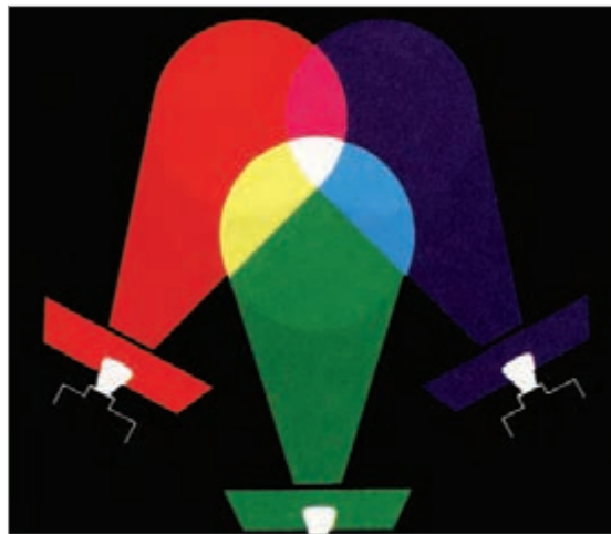
▲ تصویر ۵-۶- وقتی سه منبع نور بنفش، سبز و قرمز با یکدیگر تلاقی کنند. در محل تلاقی آن‌ها روی صفحه سفید از طریق ترکیب افزایشی نور سفید حاصل می‌شود زیرا هر سه طیف کوتاه، متوسط و بلند نور را در خود دارند.
